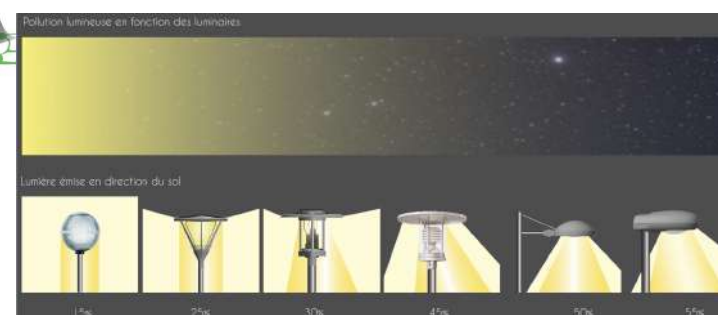
Efficacité de flux et pollution lumineuse en fonction du type de luminaire. Source : Acere.
